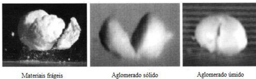
Figura 3.28 Exemplo de fratura de impacto para três tipos genéricos de aglomerados
