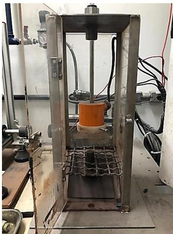
Figura 4.9 Célula de Carga de Impacto (CCI)
