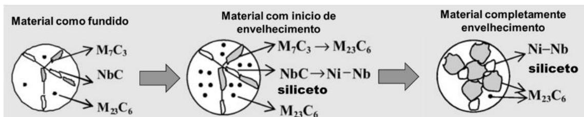
Figura 8: Evolução da precipitação nas ligas HP, modificado de (SHI & LIPPOLD, 2008).
