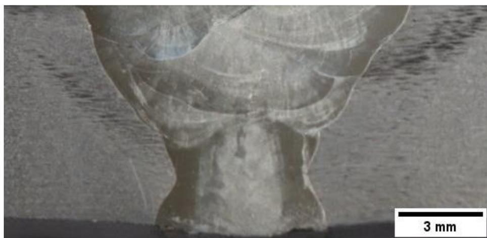
Figura 27 - Macrografia da região da raiz da junta soldada.
