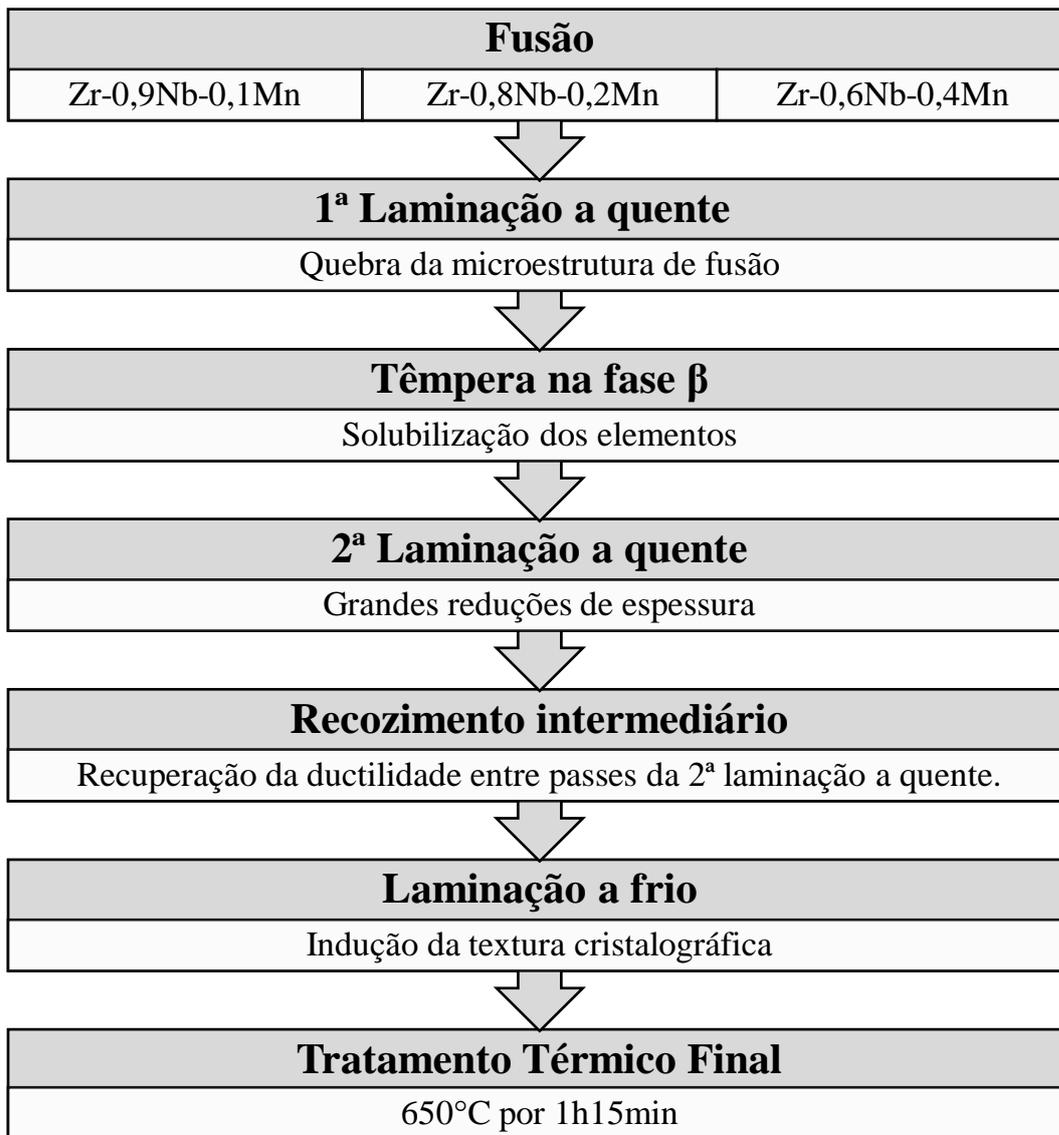
Figura 46: Rota de processamento das ligas Zr-0,9Nb-0,1Mn; Zr-0,8Nb-0,2Mn e Zr-0,6Nb-0,4Mn.
