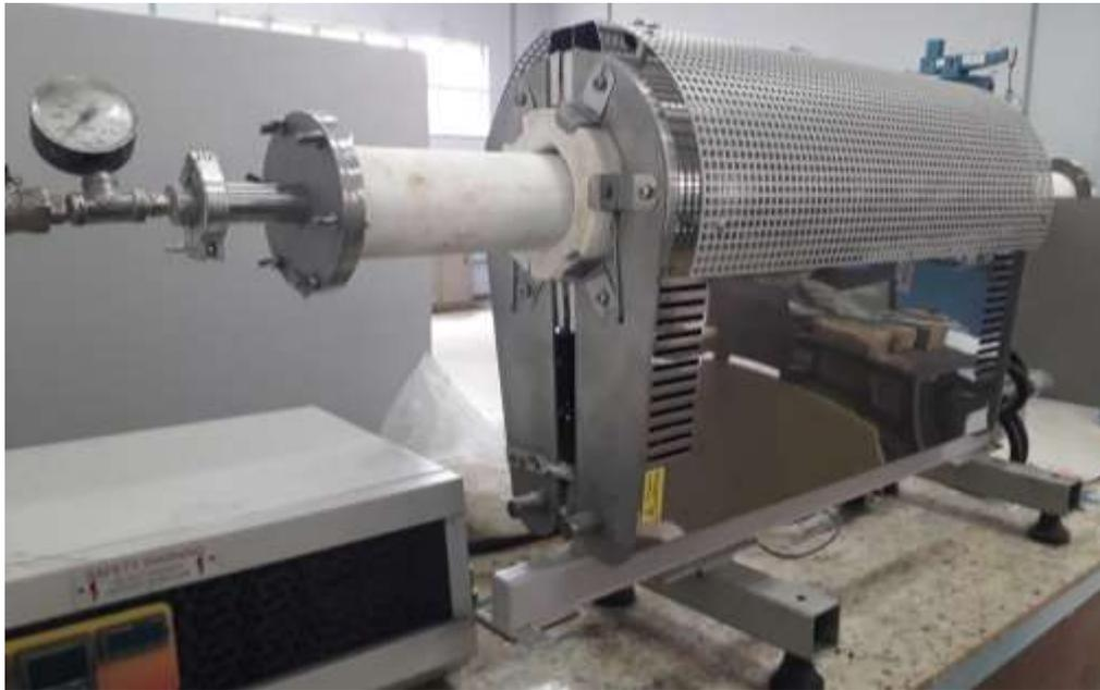
Figura 48: Forno tubular de três zonas equipado com sistema a vácuo.
