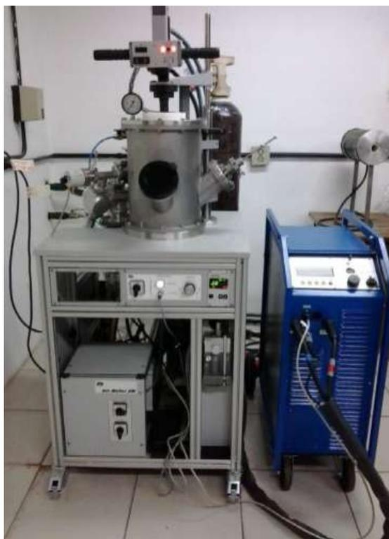
Figura 45: Forno elétrico a arco Bühler AM-VARIO 400.
