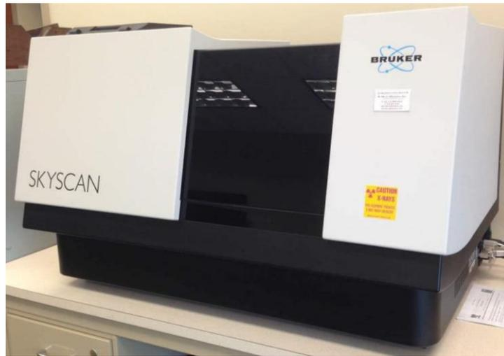
Figura 21 – Equipamento utilizado para análise de microtomografia.
