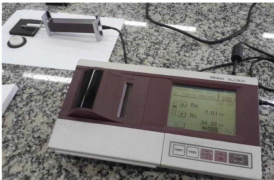
Figura 23 – Aparato utilizado no teste de medição de rugosidade.
