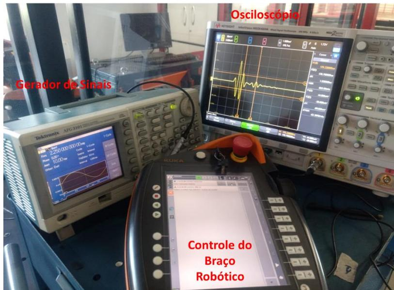
Figura 26 – Aparato para geração e captação do sinal no teste de incidência sônica multiangular
