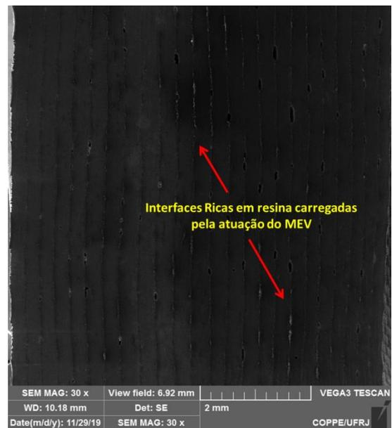
Figura 34 – Imagens MEV com diferentes aumentos (200,500,2000 e 30x) da seção transversal de uma placa do laminado unidirecional  $[0^\circ]_{12s}$ .
