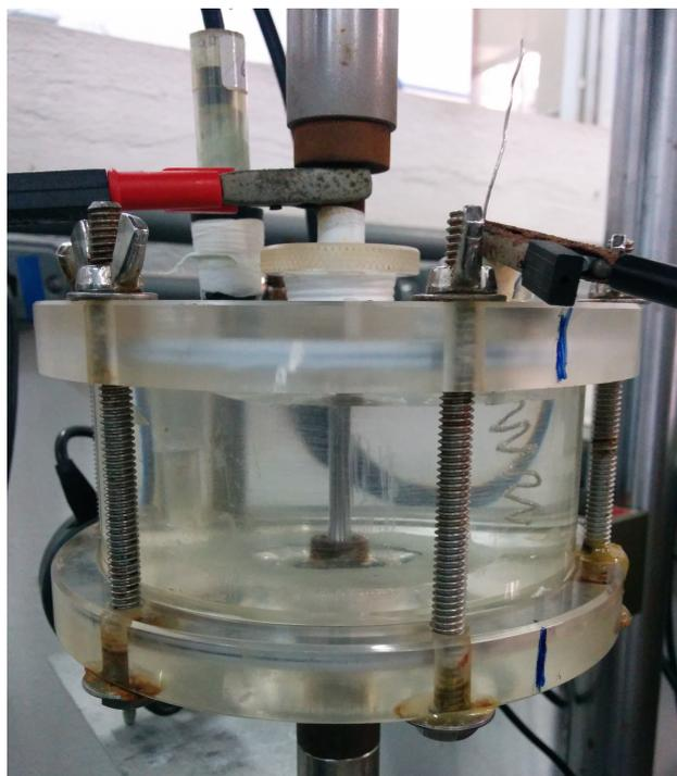
Figura 3.5: Ensaio de tração BTM em célula eletroquímica.
