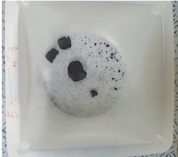
**Figura 4.27:** Pelota com 5% de redução fragmentada após 9 impactos de uma altura de 1 metro.
