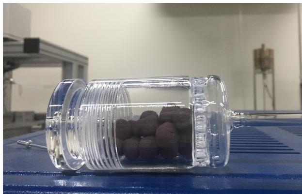
**Figura 4.12:** Disposição das pelotas no cadinho a ser introduzido no interior do forno para processo de redução.
