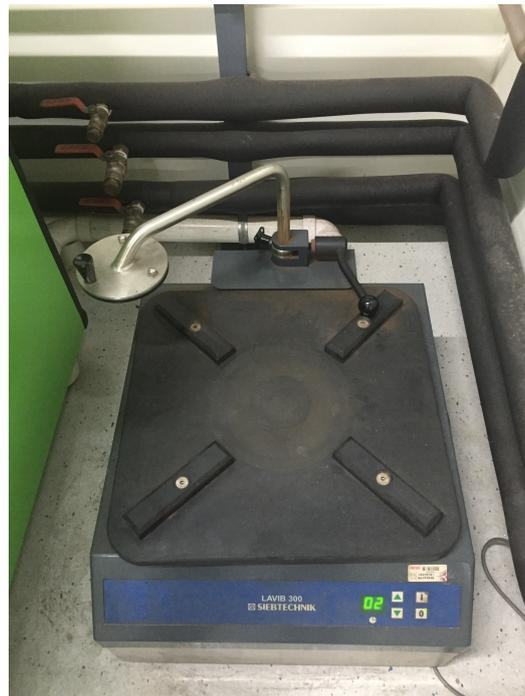
**Figura 4.23:** Equipamento vibratório utilizado no peneiramento.
