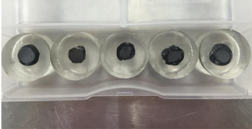
**Figura 4.18:** Embutimento final das pelotas reduzidas.
