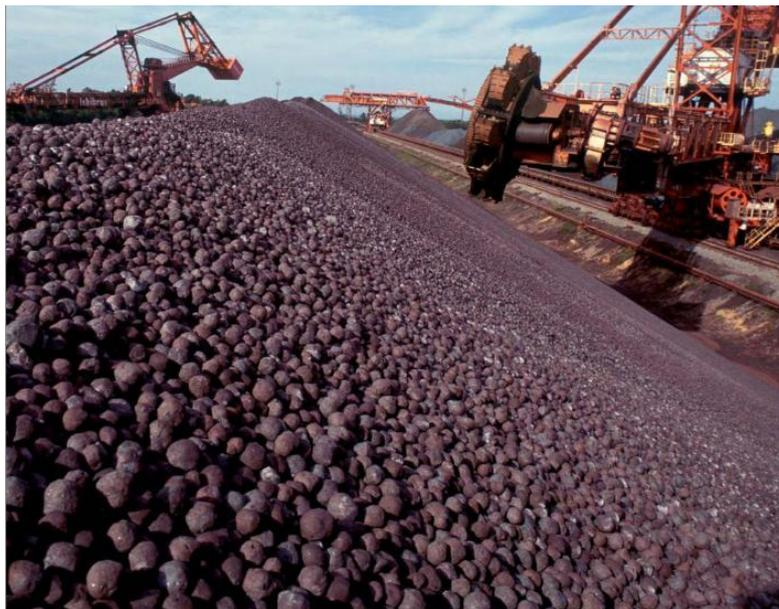
**Figura 3.1:** Pilha de pelotas de minério de ferro disposta em pátio de matérias primas (VALE, 2012).
