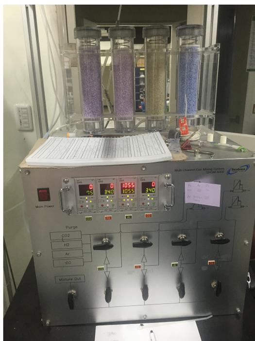
**Figura 4.14:** Controlador de vazão dos gases redutores Seahwa Hightech SHGM-4000.
