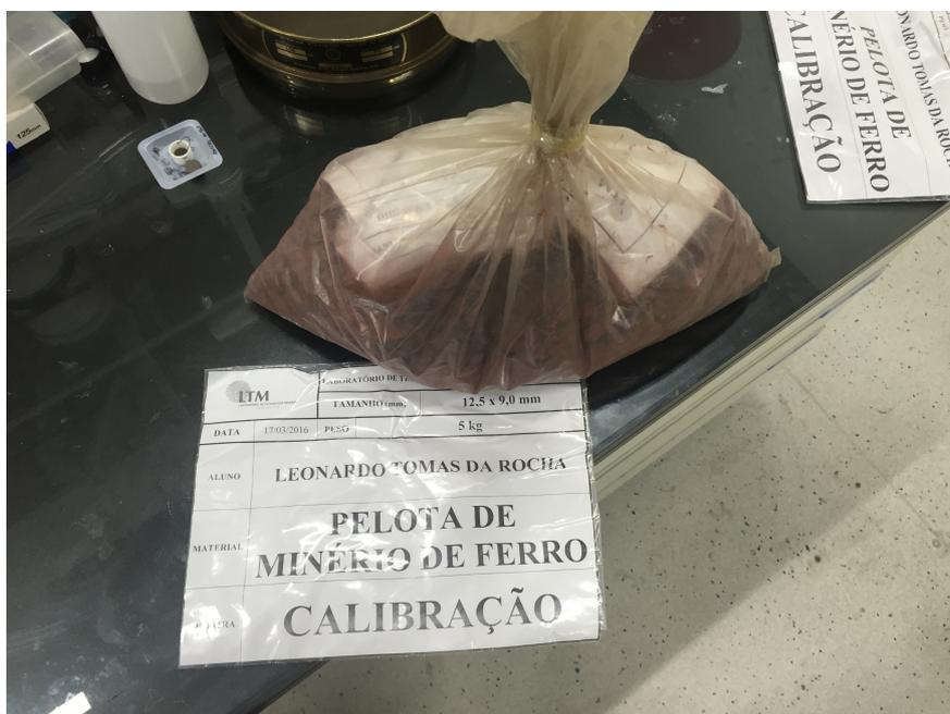
**Figura 4.1:** Amostra de pelotas de minério de ferro.
