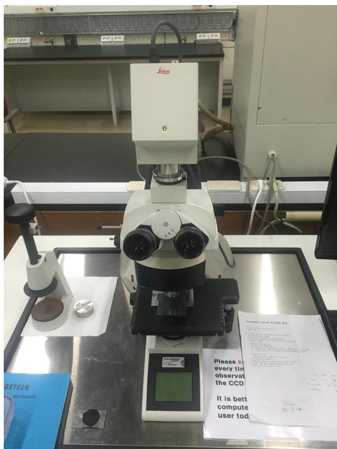
Figura 4.15: Microscópio Óptico Leica 4.3.
