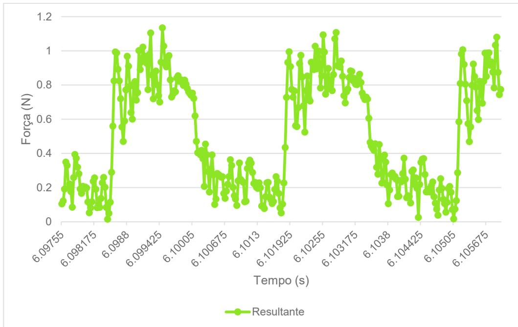
**Figura 4-38 Força resultante em Newtons no mesmo período da figura 4-37 do corte da amostra de ECAP quatro passes de cartucho recozido sob avanço de 18 mm/min**
