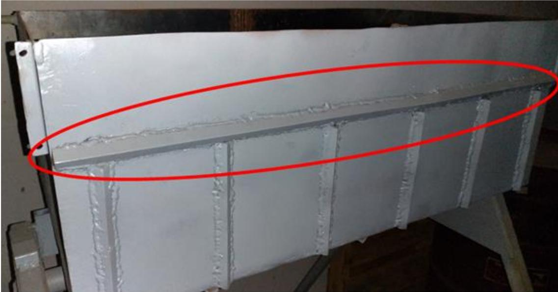
Figura 29 Reforços estruturais para evitar a deformação, instalados após os testes.
