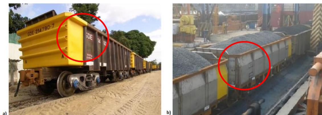
Figura 3 Diferentes geometrias de vagões, a) Vagão GDT comum e b) Vagão desenvolvido pela empresa X, feito em aço inoxidável e geometria da chapa lateral modificada para evitar a adesão e comportar mais material.
