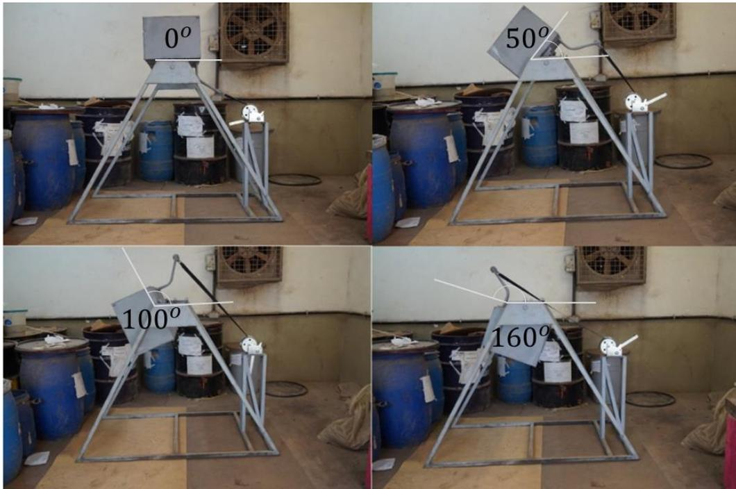
Figura 17 Diferentes etapas da rotação do Virador.
