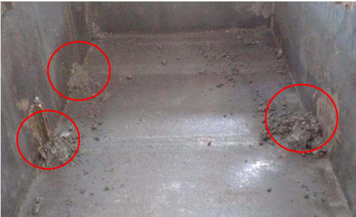
Figura 27 Efeito da ZTA, demarcada em vermelho e da corrosão localizada na adesão do material com 4,4 % de teor de umidade.
