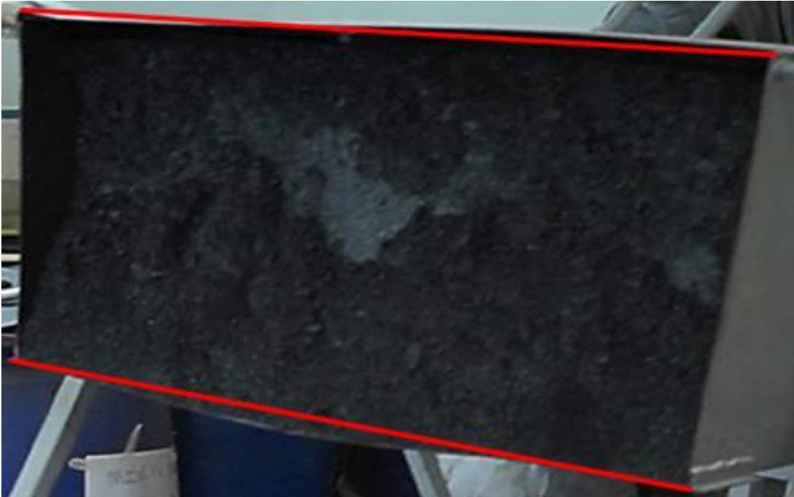
Figura 28 Deformação do EVL durante o descarregamento, as linhas vermelhas indicam a posição retilínea das faces.
