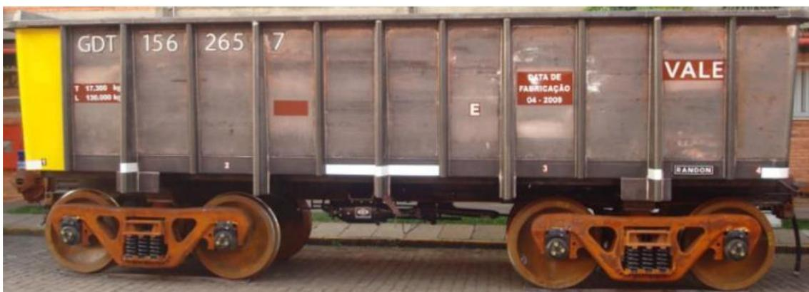
Figura 8 Vagão modelo GDT (Trentin, 2015).
