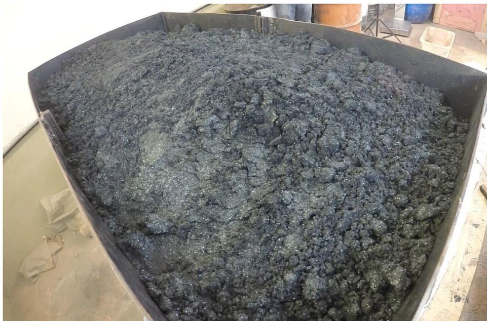
Figura 18 Disposição inicial de 184 kg do *pellet feed* antes da viragem com 95% de enchimento.
