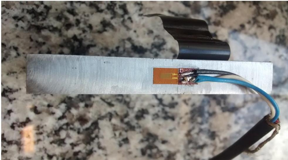
Figura 21. Strain gauge na posição de projeto para BFS
