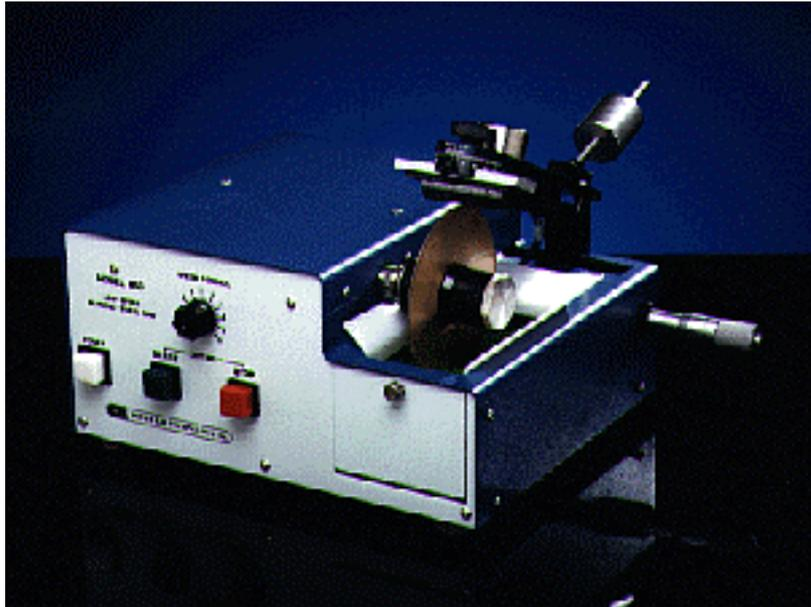
Figura 19: Fotografia do aparelho utilizado para o corte do cilindro supercondutor.
