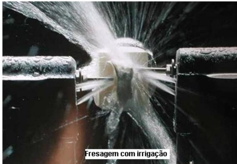
FIGURA 17: Fresagem do Sistema Cerec. Modificada da Fonte: <http://www.cerec3d.it/page7/page7.html>, acessada em 07/02/2010.
