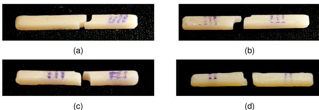
Figura 52. Amostras fraturadas após o ensaio de flexão; (a) Z350, (b) FS, (c) TPH3 e (d) CA.
